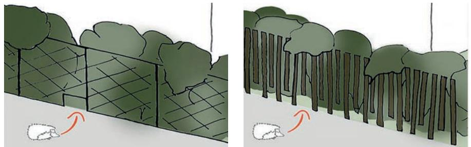
Principe de perméabilité écologique des clôtures © AUDAT.VAR
